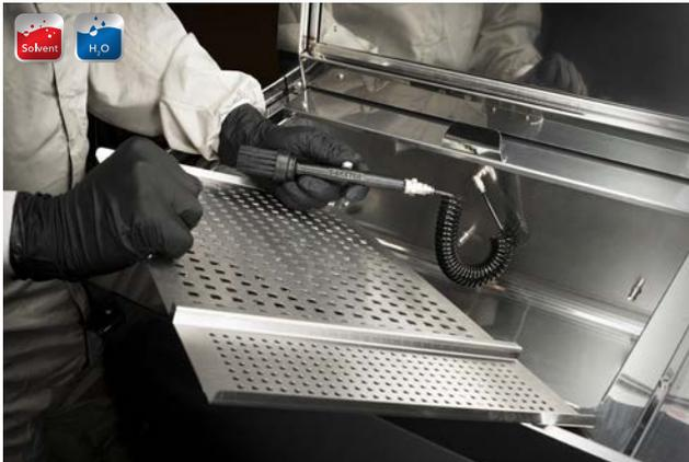
Alle Waschplätze verfügen über leicht abnehmbare Arbeitsgitter. Sehr einfach zu reinigen mit glatt verschweißten Innenkanten.
